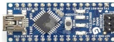
Gambar 2.1 Arduino Nano tampak dari depan
